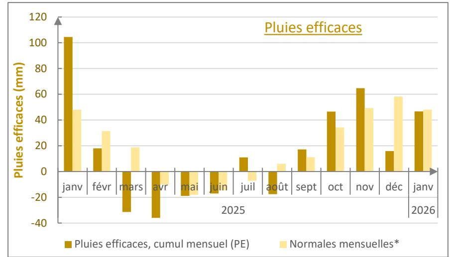
Pluies efficaces (PE) : précipitations qui ruissellent et s'infiltrent dans le sol, contribuant potentiellement à la recharge effective des nappes (en mm).
